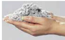
です。1本1本の繊維の中にある空気泡が高い断熱性を発揮します。機械を使って柱と柱の間などに吹き込み、または吹きつけます。筋かいが通るような施工がしにくい場所でも確実に断熱材を入れられるのが特徴です。また、木質繊維のため素材そのものが湿気を吸収・放出することから、結露が起きにくいというメリットがあります。防音・防虫効果があり、防火性にも優れています。
